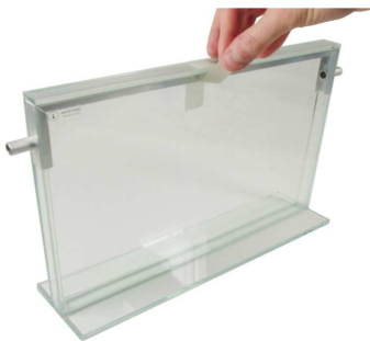
Abbildung 1: Die Sicherung bzw. Klebestreifen entfernen. Falls Kleberückstände vorhanden, bitte mit Alkohol entfernen.
