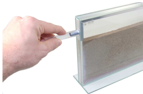
Abbildung 10: Den Schlauch auf die Buchse stecken.
